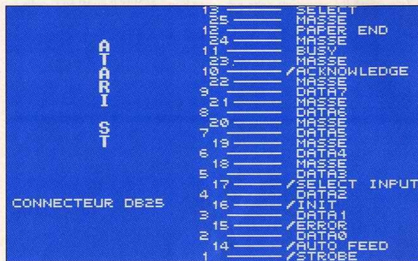
Sur la figure 1 vous pouvez voir le brochage de ce connecteur.
